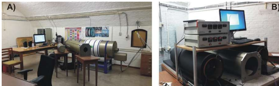
Figura 3.17. A) Magnetómetro 2G DC-SQUID y B) horno ASC TD48-SC del laboratorio de paleomagnetismo Fort Hoofddijk de la Universidad de Utrecht (Holanda).
