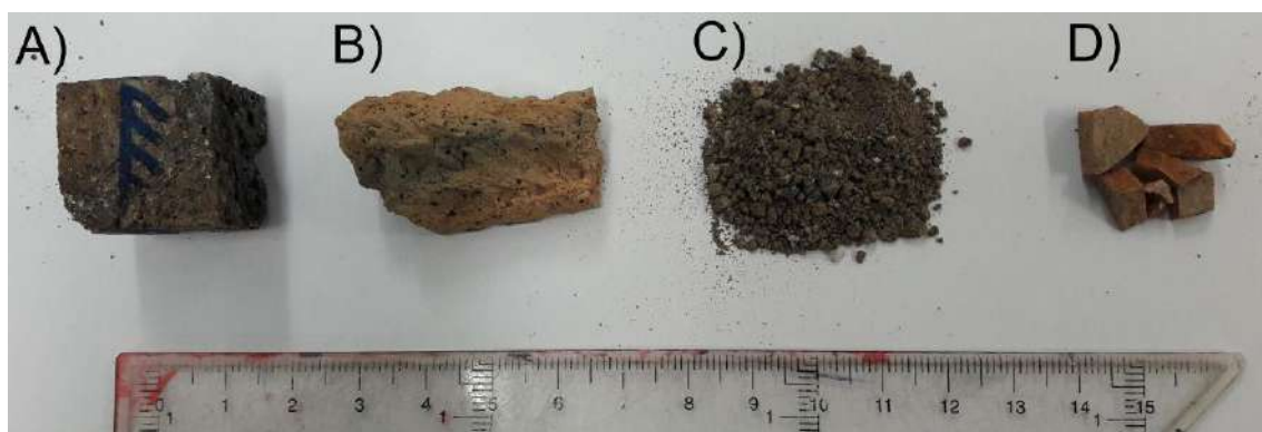
Figura 3.1. A) Espécimen submuestreado orientado. B) Muestra no orientada sin submuestrear. C) Muestra no orientada pulverizada. D) Fragmento de cerámica no orientada y submuestreada. Escala de la regla en cm: 1cm.
