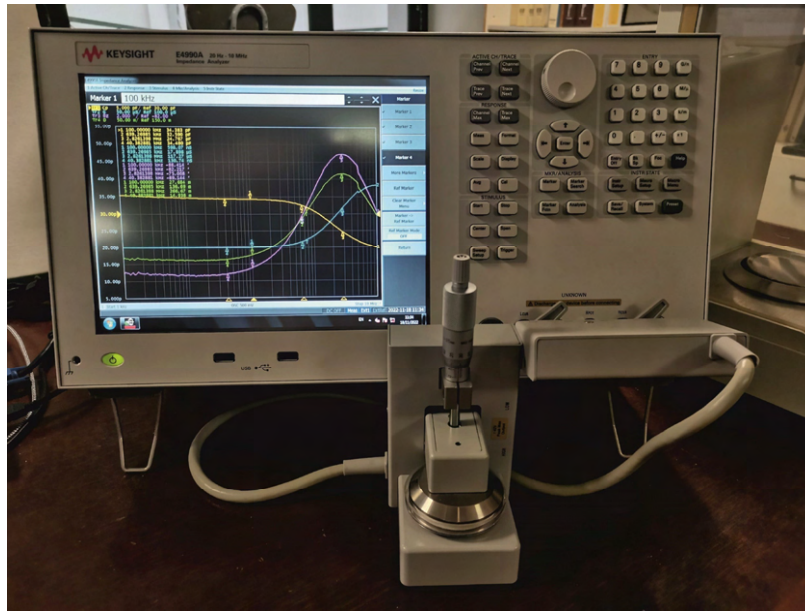
Figura 7.2.1. Equipo de medida utilizado para la adquisición de datos de permitividad eléctrica. En la imagen se puede observar el analizador de impedancias y en primer plano el accesorio utilizado como condensador de placas paralelas.
