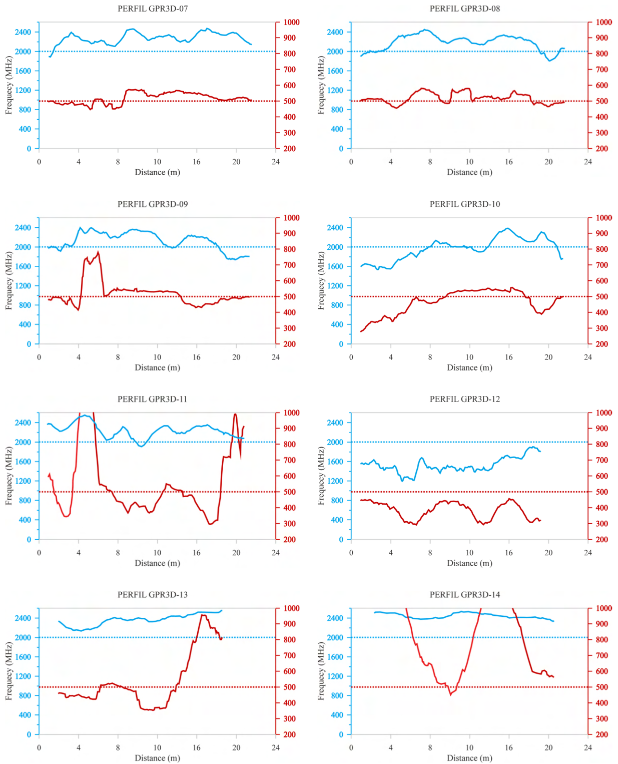
Figura I.2. Resultados obtenidos para la frecuencia dominante (rojo) y el ancho de banda (azul) en los perfiles GPR3D-07 a GPR3D-14.
