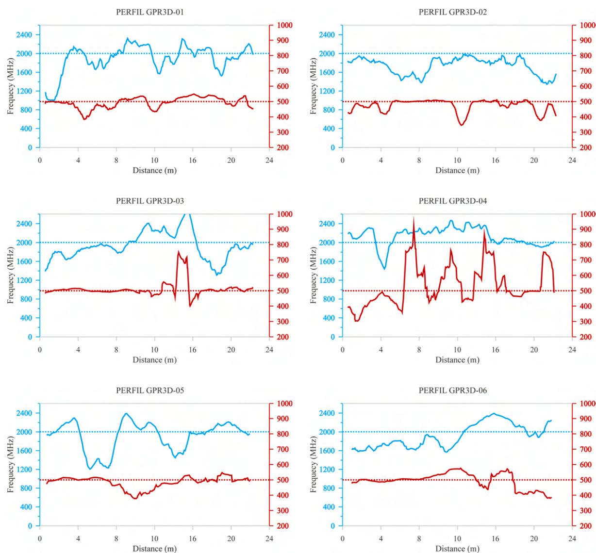
Figura I.1. Resultados obtenidos para la frecuencia dominante (rojo) y el ancho de banda (azul) en los perfiles GPR3D-01 a GPR3D-06.
