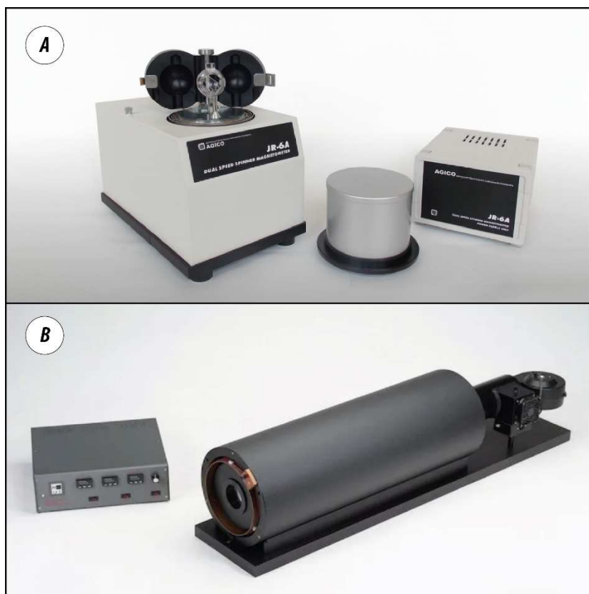
Figura 4.9: Equipos utilizados para el estudio paleomagnético. A) Magnetómetro JR-6 Dual Speed Spinner (AGICO). B) Horno de desmagnetización modelo ASC TD48-DC (ASC Scientific).
