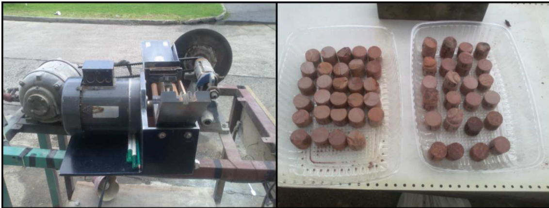
Figura 4.7: detalle de la rebanadora (izquierda) utilizada para obtener los especímenes de tamaño estándar (derecha).
