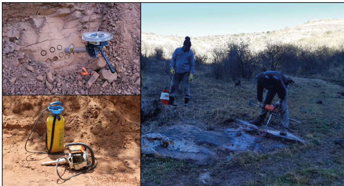
Figura 4.6: Derecha: muestreo de campo y herramientas utilizadas para el desarrollo del mismo. Izquierda arriba: clinómetro/orientador; Izquierda abajo: perforadora con bomba de agua. En cada sitio de muestreo se obtienen más de seis especímenes para mejorar la estadística
