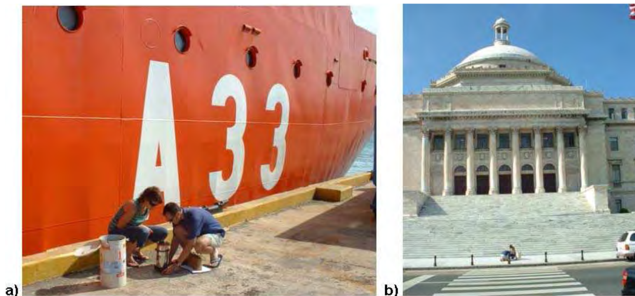
Fotografía IV.5 Fotos del procedimiento de enlace del gravímetro marino con las redes terrestres mediante el gravímetro portátil Worden. a) Medición con gravímetro portátil en el muelle La Pinilla. b) Medición con el gravímetro portátil en la base gravimétrica absoluta en el Capitolio de San Juan de Puerto Rico.
