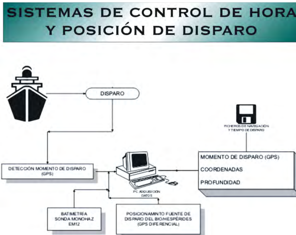
Figura III.10 Esquema de un sistema para el control y posición de disparo (tomado de Agudo, L. M., 2003).
