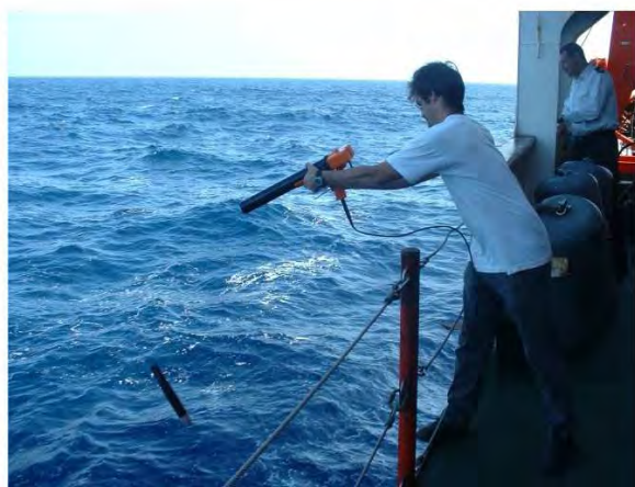
Fotografía IV.2 Lanzamiento del sensor XBT (batitermógrafo desechable).
