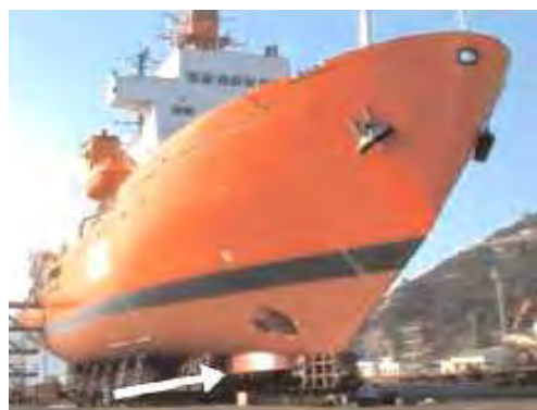
Fotografía III.3 La flecha blanca indica la localización de los transductores de la ecosonda multihaz (B.I.O. Hespérides).
