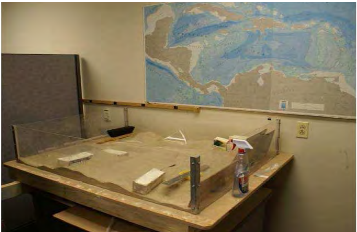
Fotografía IV.4 Caja de arena donde se desarrollaron los experimentos de la presente investigación en las instalaciones del U.S. Geological Survey en Woods Hole (EE.UU.). También se muestran el utillaje y los elementos necesarios para los diferentes diseños experimentales.
