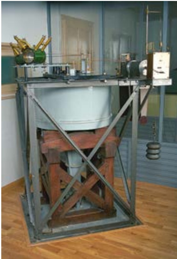
◁ Sismógrafo estático cruzado de Wiechert. Museo del Instituto Geográfico Nacional en el Observatorio de Toledo. Con él se registró el terremoto de la Toscana, a que se acaba de hacer referencia.
