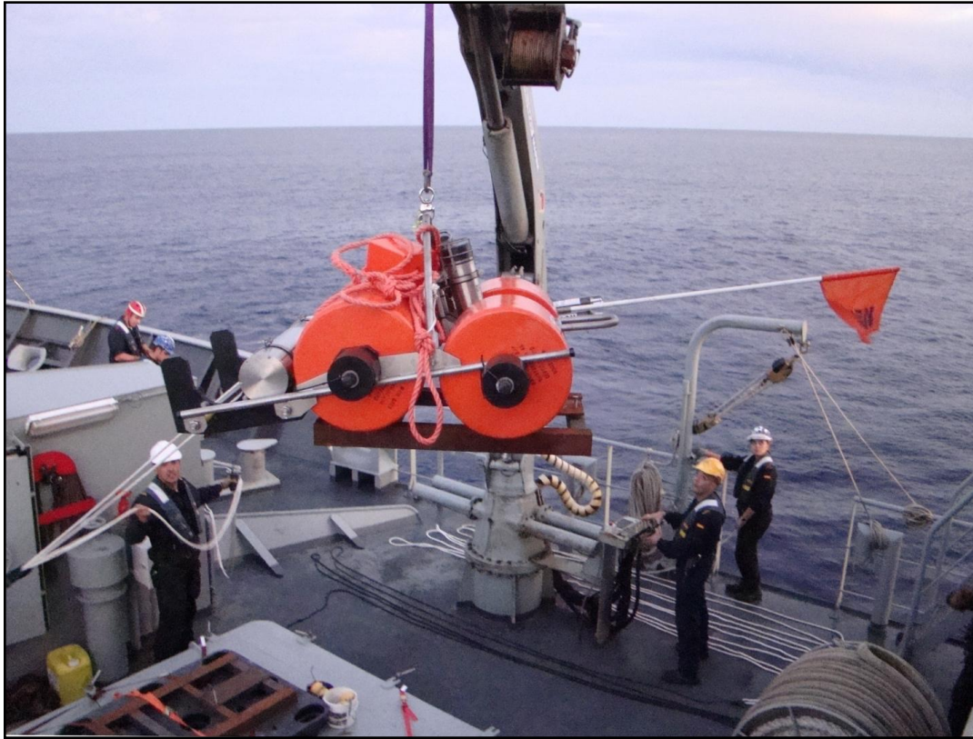
Fig. 3.1. Despliegue de OBS desde la cubierta del remolcador de la Armada Española "Mar Caribe". Cortesía del Dr. Antonio Pazos.
